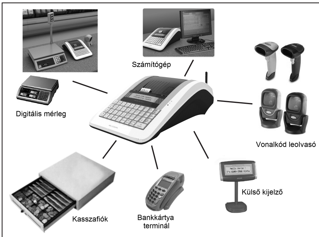
Az Euro-150TE Flexy külső csatlakoztatásai
